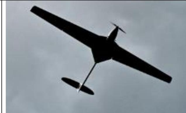
**Самолетного типа винт сзади**
