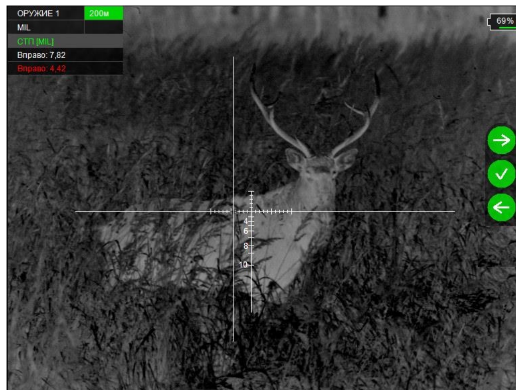
Рисунок 15 – Горизонтальная выверка
