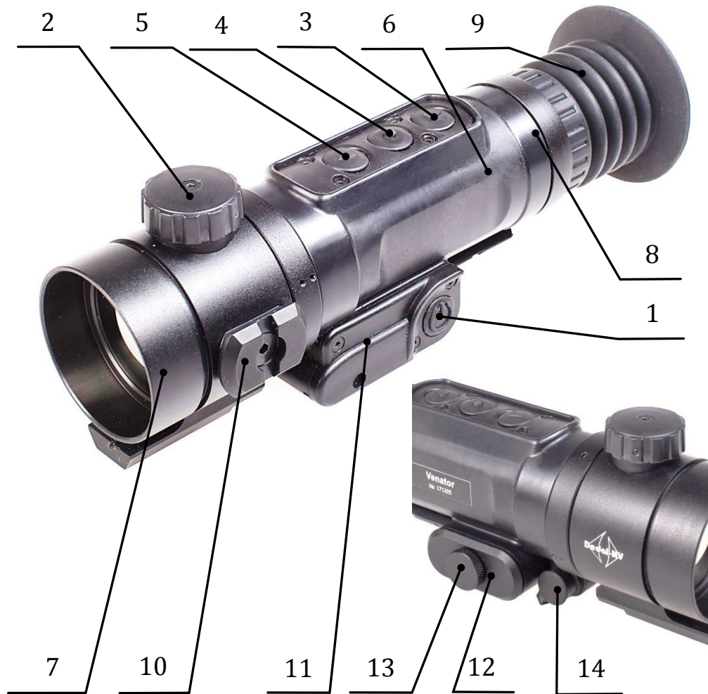
Рисунок 1 – Внешний вид прицела и органы управления
