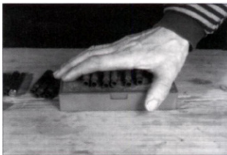
Рис. 6-7. Перед обжимкой гильзы должны быть смазаны.
