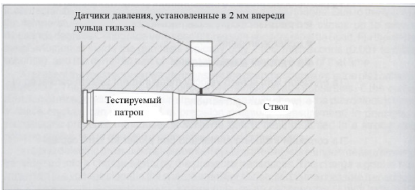
Рис. 9-2. Метод измерения давления около дульца гильзы в соответствии с СИР, 13 июня 1990 года.
