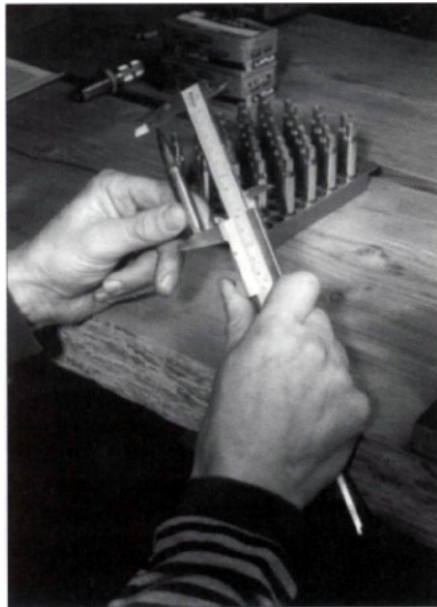
Рис. 6-16. Снаряженные патроны проверяются на правильность ОДП.
