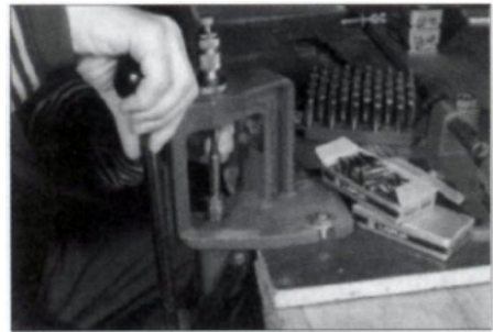
Рис. 6-15. Посадка пули осуществляется посадочной матрицей, установленной в зарядный пресс.
