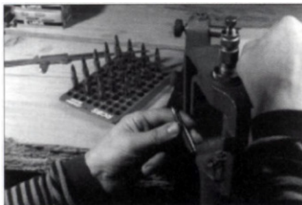
Рис. 6-16. Снаряженные патроны проверяются на правильность ОДП.
